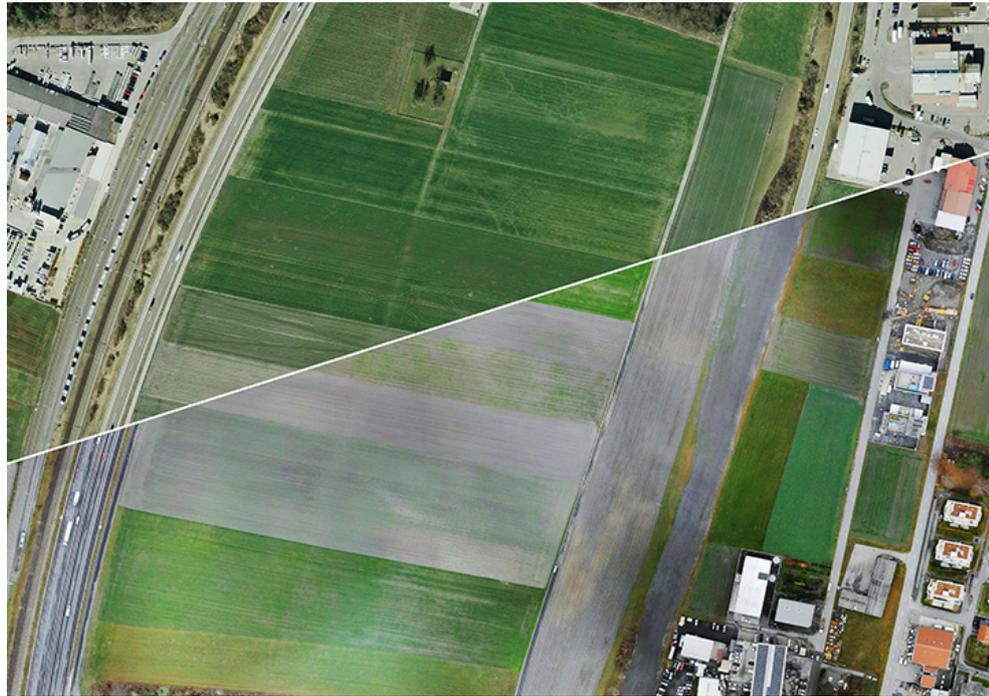
Vergleich der Orthofotos von 2014 (oben) und Dezember 2018 (unten), Neubau Nordspur (links) und Rekultivierung alter Trasse (rechts).
